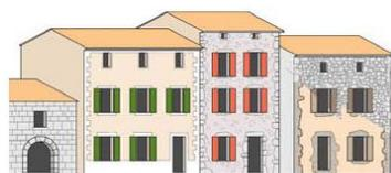
En règle générale la façade est composée d'une trame horizontale qui définit les différents niveaux du rez-de-chaussée aux combles et d'une trame verticale qui permet l'alignement des ouvertures.
