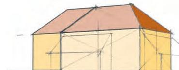
Extension du bâtiment dans la continuité du volume d'origine. La reprise au niveau de la toiture est complexe du fait des quatre pentes. La nouvelle maçonnerie est dans le même plan que l'ancienne. Il y aura des difficultés à réaliser un raccord d'enduit dans la même tonalité que l'existant
