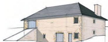
Ferme caractéristique du plateau avec l'habitat et les bêtes au rez-de-chaussée et le fourrage à l'étage, sous la charpente. La rampe permet l'accès à la grange avec un véhicule.
